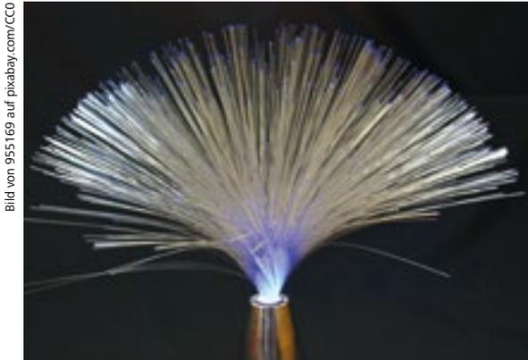
Die Glasfasern leiten das Licht, das am Boden der Lampe von einer LED-Leuchte als Strahl ausgesendet wird. Das Licht dringt am unteren Ende in die Faser ein. An der Innenseite der Faser wird das Licht immer wieder reflektiert, bis es die Faser am oberen Ende verlassen kann. Deshalb sieht man dort einen leuchtenden Punkt.
